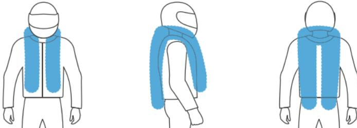
Der Airbag schützt die lebenswichtigen Bereiche bei einem Sturz oder Unfall (Brustkorb, Bauch, Halswirbelsäule, Rücken, Kreuzbein). Das Schutzhohlraumvolumen fängt Stöße wirksam ab und die Form des aufgeblasenen Airbags stabilisiert den Oberkörper, wodurch das Risiko einer Überstreckung der Wirbelsäule verringert wird.
