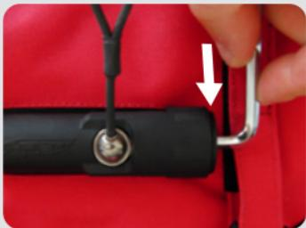
Terminez le vissage avec la clé Allen en maintenant toujours la bille. Arrêtez de visser dès que le bouchon est en contact avec le cylindre du percuteur. Ne serrez pas trop fort au risque d'endommager le bouchon ou le pas de vis.
