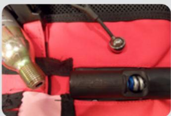
Durch die Aktivierung des mechanischen Systems (Airbagauslösung), ist die Metallkugel aus dem Kolben herausgesprungen und die Sprungfeder ist sichtbar. Schrauben Sie die leere CO<sub>2</sub>-Kartusche heraus und ersetzen diese.
