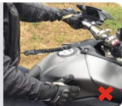
Kontrollera att den fäspunkt som valts är tillräckligt stabil, bör tåla minst 150kg.
