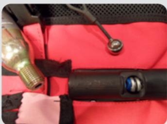
Po aktivaci mechanického systému (nafouknutí airbagu) je kulička vytržena a pružina je viditelná. Odšroubujte prázdnou CO2 bombičku a vyjměte ji.
