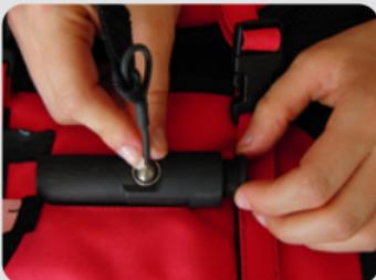
Plaats de kogel terug in de zuiger zorg ervoor dat de ring rond de kogel mooi gelijk aanpast in de cilinder. Draai de sluitschroef terug vast – houdt hierbij eerst de kogel tegen zodat hij niet loskomt terwijl u de schroef vast zet.
