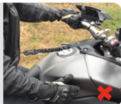
Scegliere un punto solido e robusto, resistente ad oltre 150 kg. Evitare che il cavo venga in contatto con una parte calda o tagliente.
