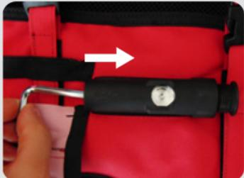
Remettez le piston en place à l'aide de la clé Allen ou de votre doigt. Veillez à ce que l'encoche du piston soit bien en face du trou où viendra se placer la bille.
