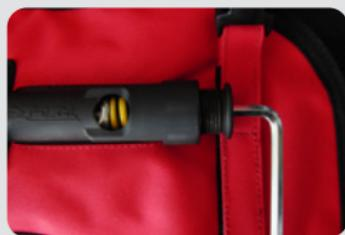
Schrauben Sie die Abdeckkappe mithilfe des Inbusschlüssels los, der im Lieferumfang enthalten ist. Schrauben Sie die Abdeckkappe nicht komplett heraus, sondern nur so weit, dass Sie den Kolben wieder in seine ursprüngliche Position bringen können.
