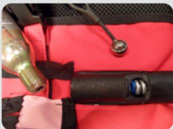
När ai-bagen har utlösats har kulans dragits ur sitt fäste och fjädern är synlig. Skruva loss den tomma patronen.
