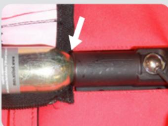
Till sist, sätt fast en ny patron och skruva den så långt det går utan alltför mycket kraft. Se till att patronen sitter fast och inte är iskruvad snett eller har "hoppat över" några gängor. Om så är fallet, skruva loss patronen och börja om från början.
