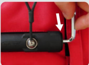
Finisci avvitando la vite con la chiave esagonale mentre tieni ferma la chiave a sfera. La vite deve essere in contatto con il cilindro. Non stringere troppo la vite per non danneggiare essa o le altre parti.
