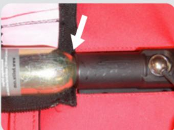
Nakonec vložte novou CO<sub>2</sub> bombičku a zcela ji zašroubujte. Ujistěte se, že je bombička dostatečně utažena a není přišroubována do strany. Pokud se vaše bombička nezašroubovala snadno bez výrazné síly, je možné, že jste během šroubování přeskočili jeden závit. V takovém případě odšroubujte bombičku a začněte znova, dokud se vaše bombička nezašroubuje snadno.
