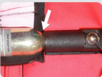
Ultima etapa, poner un nuevo cartucho CO2 y atornillarla completamente sin forzar. Asegúrate de que el cartucho este suficientemente atado o que no esté atado de través.
