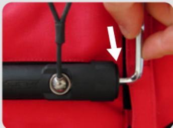
Schrauben Sie die Abdeckkappe mit dem Inbusschlüssel fest während Sie weiterhin die Metallkugel festhalten. Die Abdeckkappe muss den Zylinder berühren. Achten Sie darauf, die Teile nicht zu fest anzuschrauben oder zu beschädigen.
