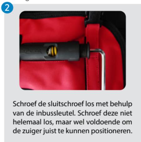
Schroef de sluitschroef los met behulp van de inbussleutel. Schroef deze niet helemaal los, maar wel voldoende om de zuiger juist te kunnen positioneren.
