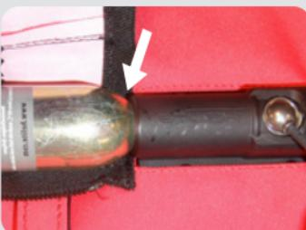
Per ultimo, inserisci una nuova bomboletta di CO2 e avvitala completamente senza forzare. Assicurati che la bomboletta sia sufficientemente stretta o avvitata ai suoi lati. Se la tua bomboletta non si avvia facilmente senza una forza significativa è possibile che tu l'abbia avvitata in modo scorretto. In questo caso, svita la bomboletta e ricomincia il processo di nuovo.
