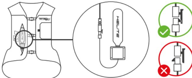
Vérifier que la e-cartouche soit correctement branchée à la carte électronique CDU. Ouvrir la poche située sur le côté droit du gilet airbag. Vérifier le branchement : connecteur dans le bon sens et verrouillé. Refermer la poche.
