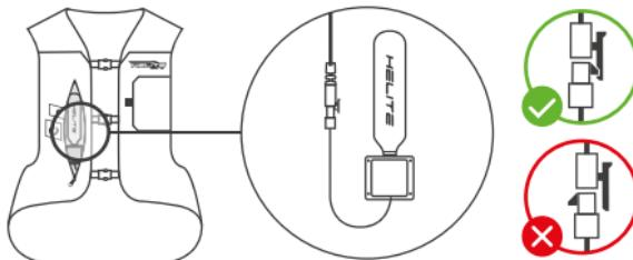
Überprüfen Sie bitte, ob die Kartusche an die elektronische CDU-Karte angeschlossen ist. Öffnen Sie die Tasche auf der rechten Seite der Helite Airbag-Westen. Überprüfen Sie den Anschluss: Verbinder in die richtige Richtung und verriegelt. Schließen Sie die Tasche wieder.
