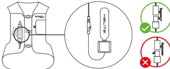
Compruebe que el cartucho electrónico esté correctamente conectado a la tarjeta electrónica CDU. Abra el bolsillo del lado derecho del chaleco airbag. Compruebe la conexión: conector en el sentido correcto y seguro. Cierra el bolsillo.
