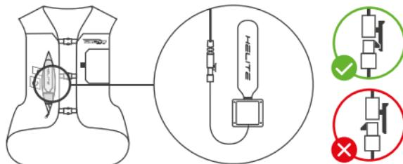
Verificare che la cartuccia elettronica sia correttamente collegata alla scheda elettronica CDU. Aprire la tasca situata sul lato destro del giubbotto airbag. Verificare la connessione: connettore nella giusta direzione e bloccato. Richiudere la tasca.
