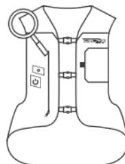
**2** Retire el cartucho vacío. Para acceder al cartucho, abra el bolsillo situado en el lado derecho del chaleco airbag. Desconecte el cartucho
