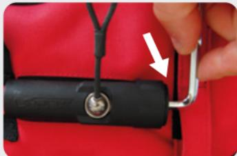
Terminez le vissage du bouchon avec la clé Allen en maintenant toujours la bille. Le bouchon doit être en contact avec le cylindre. Ne serrez pas trop fort au risque d'endommager les pièces.
