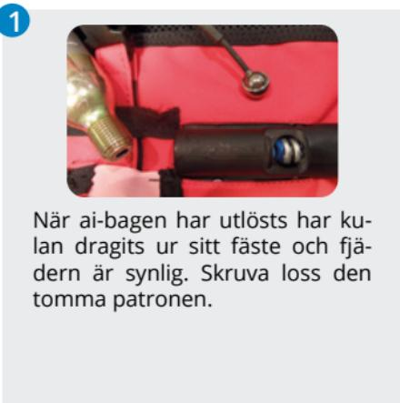
När ai-bagen har utlösats har kulan dragits ur sitt fäste och fjäder är synlig. Skruva loss den tomma patronen.
