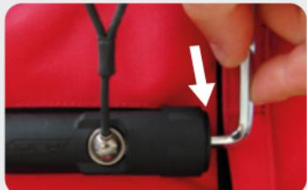
Schrauben Sie die Abdeckkappe mit dem Inbusschlüssel fest während Sie weiterhin die Metallkugel festhalten. Die Abdeckkappe muss den Zylinder berühren. Achten Sie darauf, die Teile nicht zu fest anzuschrauben oder zu beschädigen.
