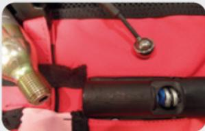
Durch die Aktivierung des mechanischen Systems (Airbag-Auslösung), ist die Metallkugel aus dem Kolben herausgesprungen und die Sprungfeder ist sichtbar. Schrauben Sie die leere CO<sub>2</sub>-Kartusche heraus und ersetzen Sie diese.
