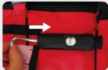
Remettez le piston en place à l'aide de la clé Allen ou de votre doigt. Veillez à ce que l'encoche du piston soit bien en face du trou où viendra se placer la bille.
