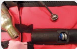
Po aktivaci mechanického systému (nafouknutí airbagu) je kulička vytržena a pružina je viditelná. Odšroubujte prázdnou CO<sub>2</sub> bombičku a vyjměte ji.
