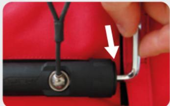
Dokončete šroubování zátoky pomocí imbusového klíče, zatímco držíte kuličku. Zátka musí být v kontaktu se spouštěcím systémem. Neutahujte příliš velkou silou a nepoškozujte součásti.
