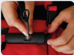
Bringen Sie die Metallkugel in Ihre ursprüngliche Position. Der Ring um die Metallkugel sollte dabei flach sein, um genau in die Öffnung zu passen. Beginnen Sie mit dem Anschrauben der Abdeckkappe per Hand während Sie die Metallkugel festhalten.
