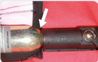
Nakonec vložte novou CO2 bombičku a zcela ji zašroubujte. Ujistěte se, že je bombička dosatečně utažena a není přišroubována do strany. Pokud se vaše bombička nezašroubovala snadno bez výrazné síly, je možné, že jste během šroubování přeskočili jeden závit. V takovém případě odšroubujte bombičku a začněte znova, dokud se vaše bombička nezašroubuje snadno.
