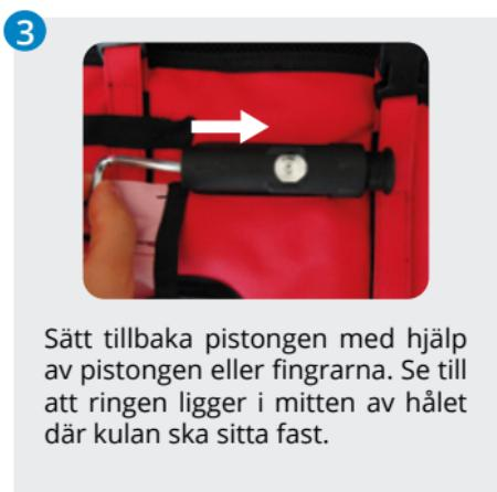
Sätt tillbaka pistongen med hjälp av pistongen eller fingrarna. Se till att ringen ligger i mitten av hålet där kulan ska sitta fast.
