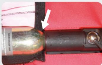
Till sist, sätt fast en ny patron och skruva den så långt det går utan alltför mycket kraft. Se till att patronen sitter fast och inte är iskruvad snett eller har "hoppat över" några gängor. Om så är fallet, skruva loss patronen och börja om från början.
