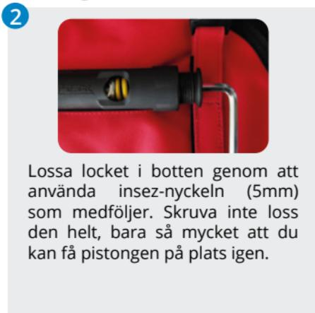
Lossa locket i botten genom att använda insez-nyckeln (5mm) som medföljer. Skruva inte loss den helt, bara så mycket att du kan få pistongen på plats igen.
