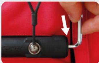
Vervolgens met behulp van de inbussleutel de schroef vastzetten. (Niet te vast; anders zou u de cilinder kunnen beschadigen).
