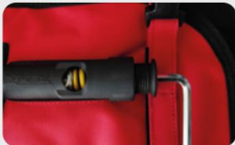
Desserrez le bouchon à l'aide de la clé Allen (5mm) fournie avec l'airbag. Ne le dévissez pas entièrement mais juste assez pour remettre le piston en place.
